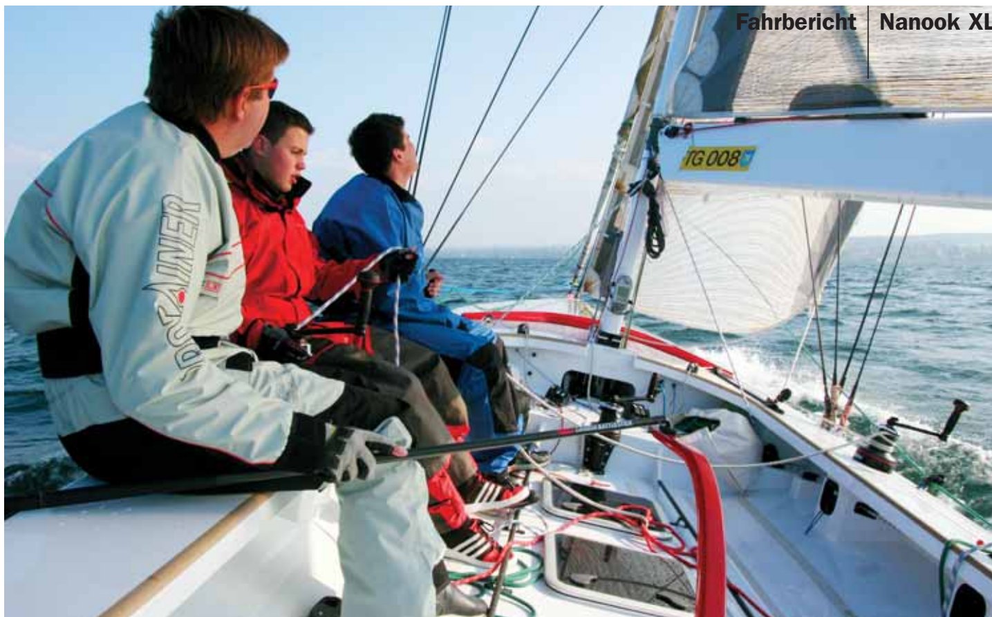
So macht segeln Spaß: Geräumiges und ergonomisches Cockpit für eine kleine Crew. Unter den Lukendeckeln befindet sich die Technik für Kiel- und Masthydraulik. Auch ein Elektroaußenborder kann dort untergebracht werden.
