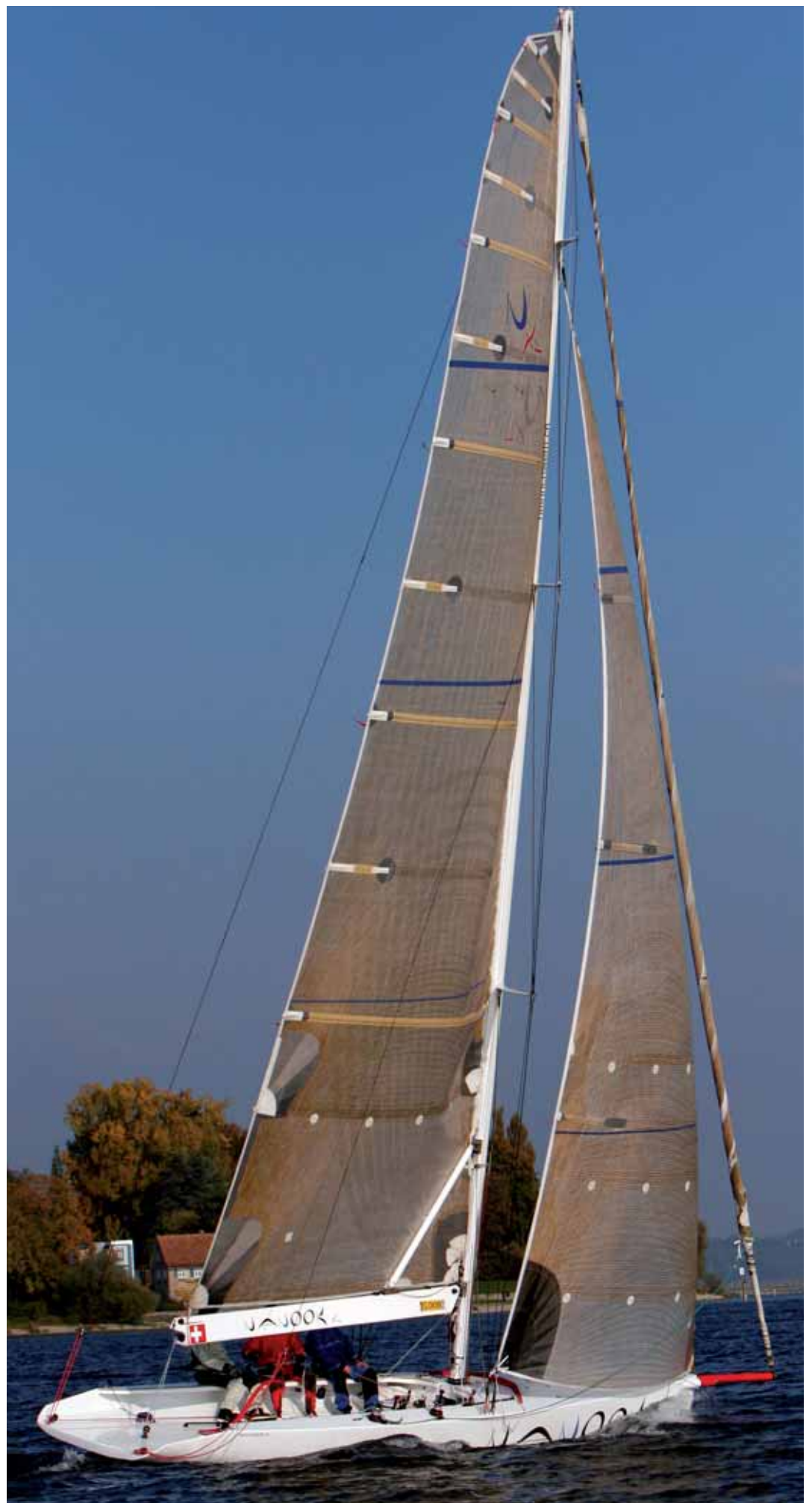
An der unteren Segellatte leicht zu erkennen ist das tiefe Profil des Großsegels, das gewaltige Kräfte erzeugt. Mit einem flachen Segel dürfte das Boot bei mehr Wind erheblich leichter zu handhaben sein, ohne bei wenig Wind wesentliche Leistungseinbußen zu verzeichnen.
