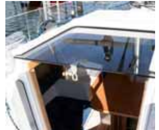
Nicht ungefährlich: Wer auf dieses dünne Schiebeluk tritt, bricht durch.
