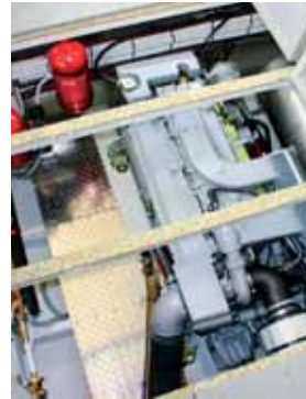
Perfekte Installation des Vetus Deutz Diesel DET A66 EMR mit 154 kW (210 PS).
