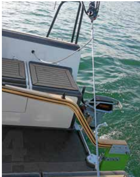
Kork im Cockpit, der Rumpf ist ein Flachs-Kork-Sandwich, einfach und zweckmäßig die Großschotführung.
