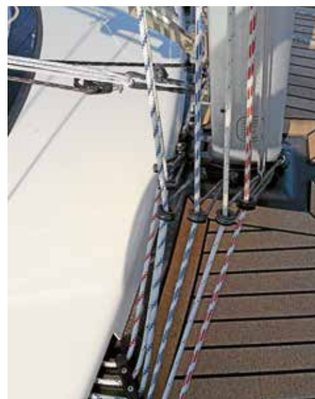
Die Fallen kommen seitlich aus dem Mast und werden bei diesem Boot über Thimbles nach hinten ins Cockpit gelenkt.
