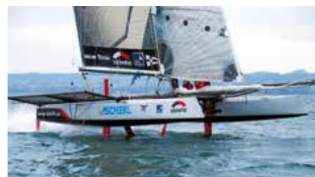
Zusätzlich zum Foil fährt Skinfit mit Schwertern. In Verdängerfahrt wäre die Abdrift zu groß. Foto: Trippolt
