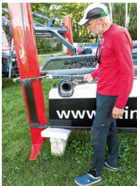
Die Neigung des Ruderblatts lässt sich mit einem Handrad verstellen. So wird der Längstrimm justiert.
