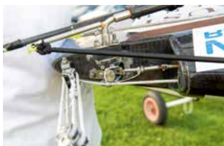
Der Carbonstab für die Höhenregulierung ist mit einer Schubstange im Bug verbunden.
