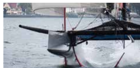
Je höher der Katamaran aus dem Wasser kommt, desto kleiner wird die benetzte Fläche des Foils. Der Auftrieb nimmt entsprechend ab. Foto: Trippolt
