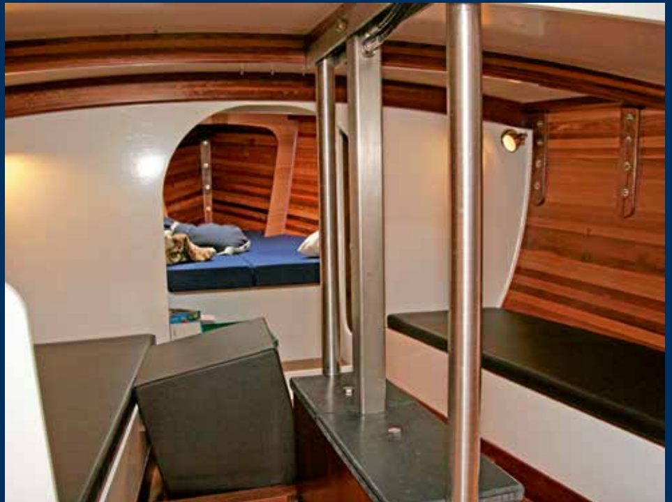
Blick ins Vorschiff. Der Raum unter dem Niedergang ist noch leer. Im Salon dominiert der Kielkasten. Im Vorschiff ist eine Doppelkoje untergebracht. Der gepolsterte Würfel dient als individuell einsetzbare Sitzgelegenheit.
