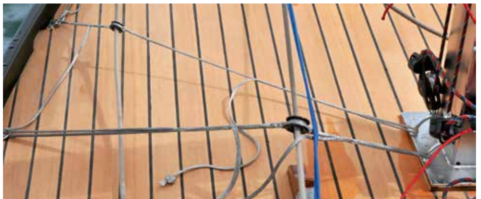
Die Holepunkte für Fock und Klüver bestehen aus Alu-Augen und hängen an einstellbaren Spleißen.
