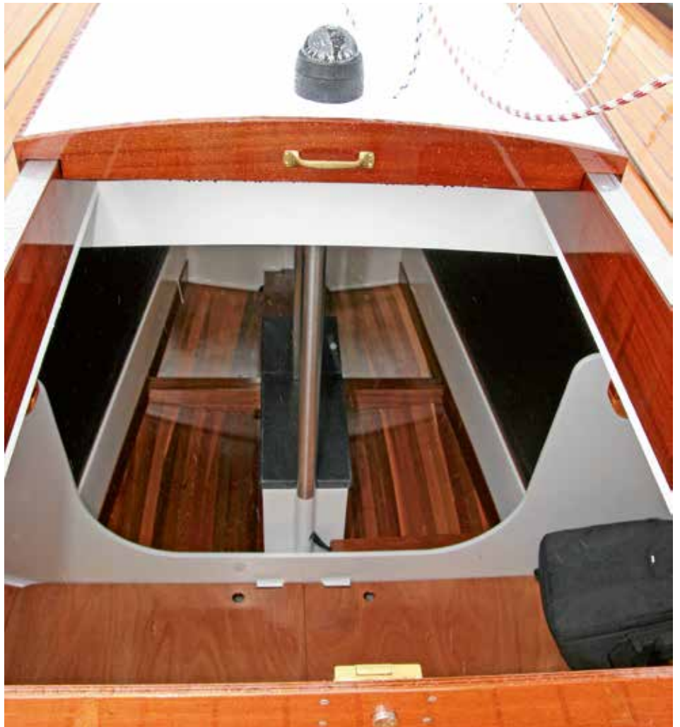
Blick durch den Niedergang unter Deck. Dass dieser bei Regenwetter immer komplett geschlossen sein muss, ist speziell bei der Baunummer eins nicht ideal, liegt aber im Ermessen des Eigners. Hier sind auch andere Lösungen möglich.
