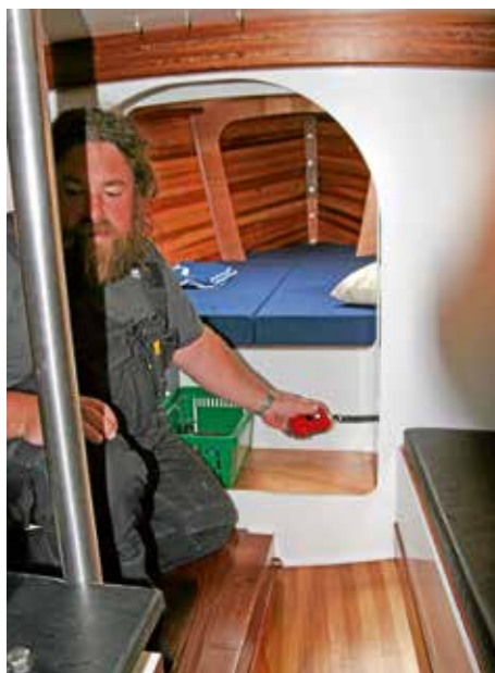
Die Steuerung für den Hubkiel ist mit Absicht so weit vom Kielkasten entfernt eingebaut. Damit möchte Stephan Züst die Unfallgefahr verringern.
