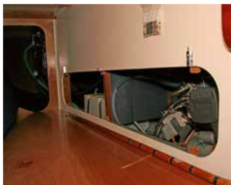
Motor und Tank sind sowohl vom Salon aus, als auch von beiden Hundekojen aus zugänglich.
