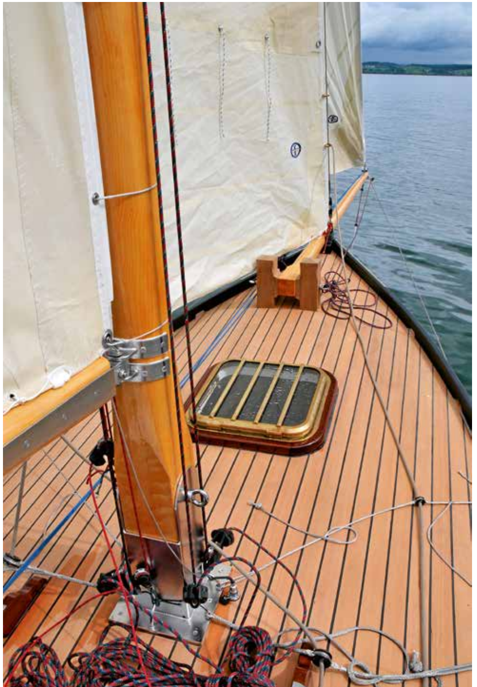
Die Beschlagsausstattung an Deck folgt der Philosophie der Einfachheit. Laschings und Spleiße dominieren die Technik. Dadurch fallen unterwegs keine aufwendigen Reparaturen an, es muss nichts gewartet werden und „Ersatzteile“ in Form von ein paar Metern Dyneema-Tauwerk lassen sich problemlos mitnehmen. Das Lager für den Klüverbaum dient gleichzeitig als Poller für die Festmacher. Belegklampen gibt es auf dem Boot ebenso wenig wie Winschen.
