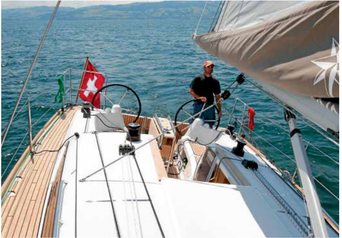
Für ein Boot der Zehn-Meter-Klasse bietet die Sun Odyssey sehr viel Platz an und unter Deck. Statt Traveller hat das Boot eine Hahnepot. Die Kontrolle des Segeltwists erfolgt über den Baumniederholer. Die Großschot ist nach der deutschen Methode geschoren und endet, zusammen mit der Fockschot, auf dem Süllrand im Griffbereich des Rudergängers. Der klappbare Spiegel ist optional. In der Standardausführung ist das Heck offen.
