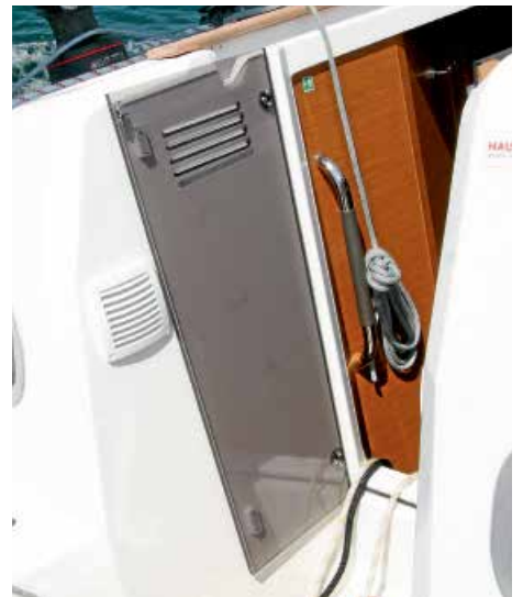
Ein loses Steckschott gibt es nicht. Die Niedergangstüren sind fest angebracht.
