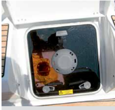
Schönes Detail: Das Luk über der Achterkabine bringt nicht nur Licht und Luft, sondern ist auch Fluchtweg.
