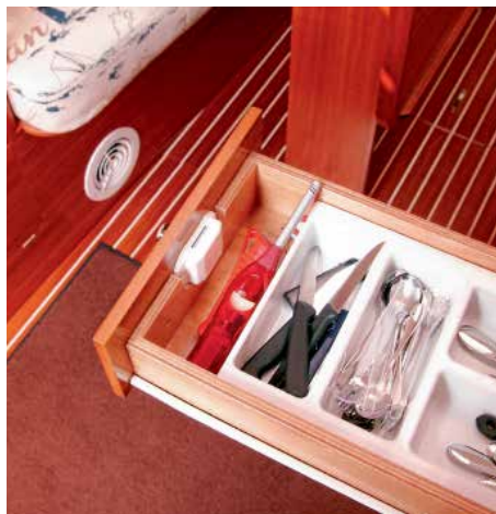
Solides Handwerk: Schubkasten mit aufgedoppelter Front.
