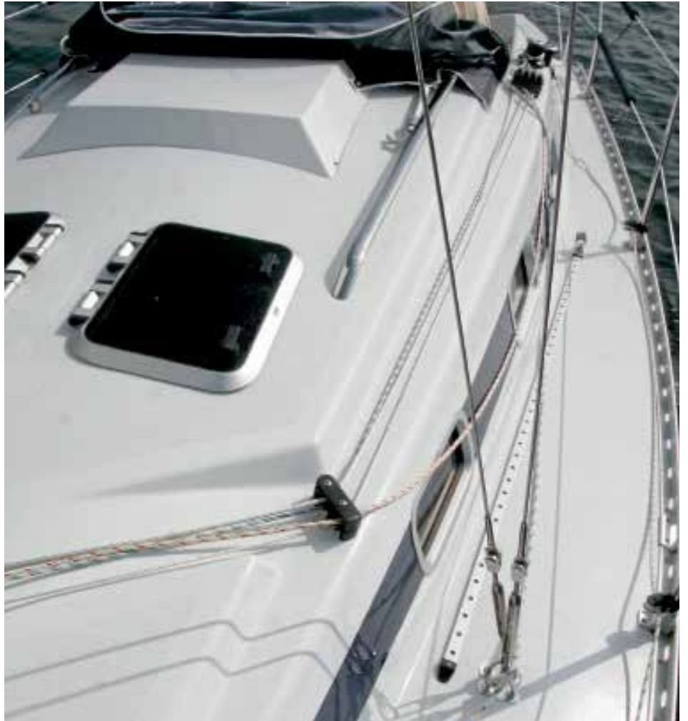
Praktisch: Die Fallen laufen außen am Aufbau entlang und werden neben der Sprayhood bedient, sodass man beim Kurbeln die Segel sieht und kontrollieren kann, was man da treibt. Die Püttings für die Wanten sind etwas nach innen versetzt. Das kommt dem Anstellwinkel der Genua zugute und die Wanten stören nicht beim Gang aufs Vordeck.
