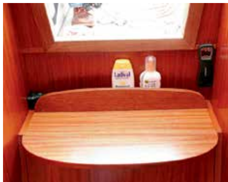
Praktisches Detail: Schwalbennest für Kleinteile hinter der obersten Niedergangsstufe.
