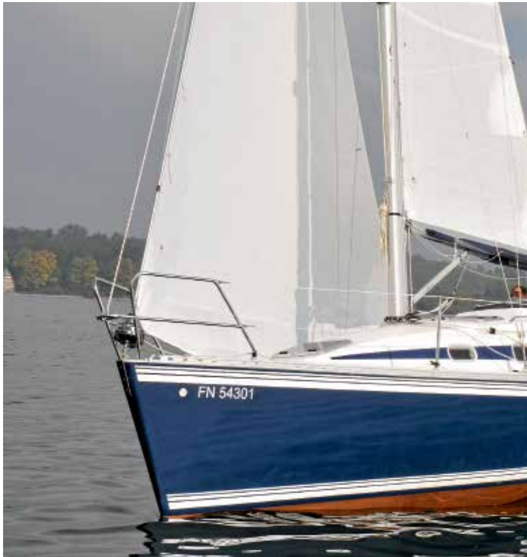
Der relativ hohe Aufbau bringt Platz unter Deck und wirkt durch seine langgezogene Linienführung trotzdem noch elegant.
