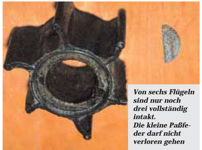
Nimmt man den Deckel ab, kommt der Impeller zum Vorschein
