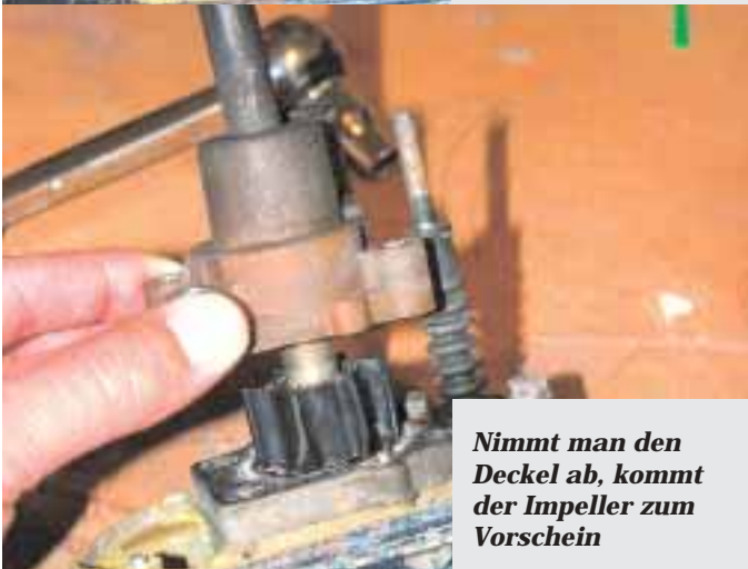
Das Pumpengehäuse sitzt auf dem Getriebeteil
