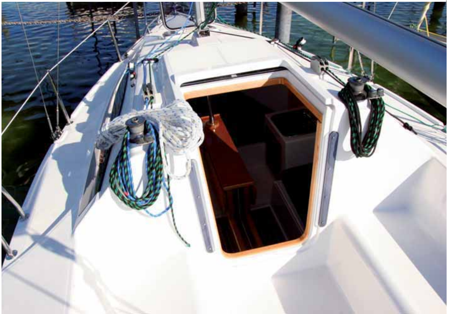
Die Bedienungselemente sind im Griffbereich der Crew. Ohne den optionalen Pinnenausleger kann der Einhandsegler diese aber nicht erreichen.
