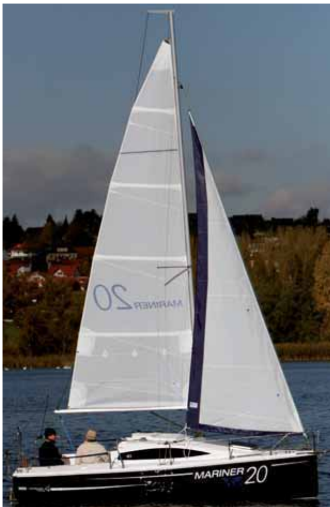
Das Großsegel ist in beiden Lieken zu kurz geraten, und auch die Fock könnte größer sein. Ohne Rollreifeinrichtung könnte der Spalt zwischen Unterliek und Deck geschlossen werden und mit zwei Latten die Mittelbreite des Vorsegels etwas überlappen und bis zur Saling reichen.
