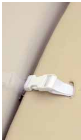
Gute Lösung: Die Vorschiffpolster werden mit solchen Gurtbandverschlüssen befestigt.
