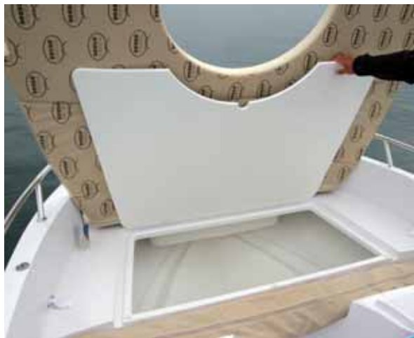
Die Vorpiek bietet Platz für allerlei leichte Ausrüstung wie Rettungswesten oder Schlechtwetterkleidung. Davor ist der flache Ankerkasten zu sehen, in den aber nur ein „Schönwetteranker“ passt.
