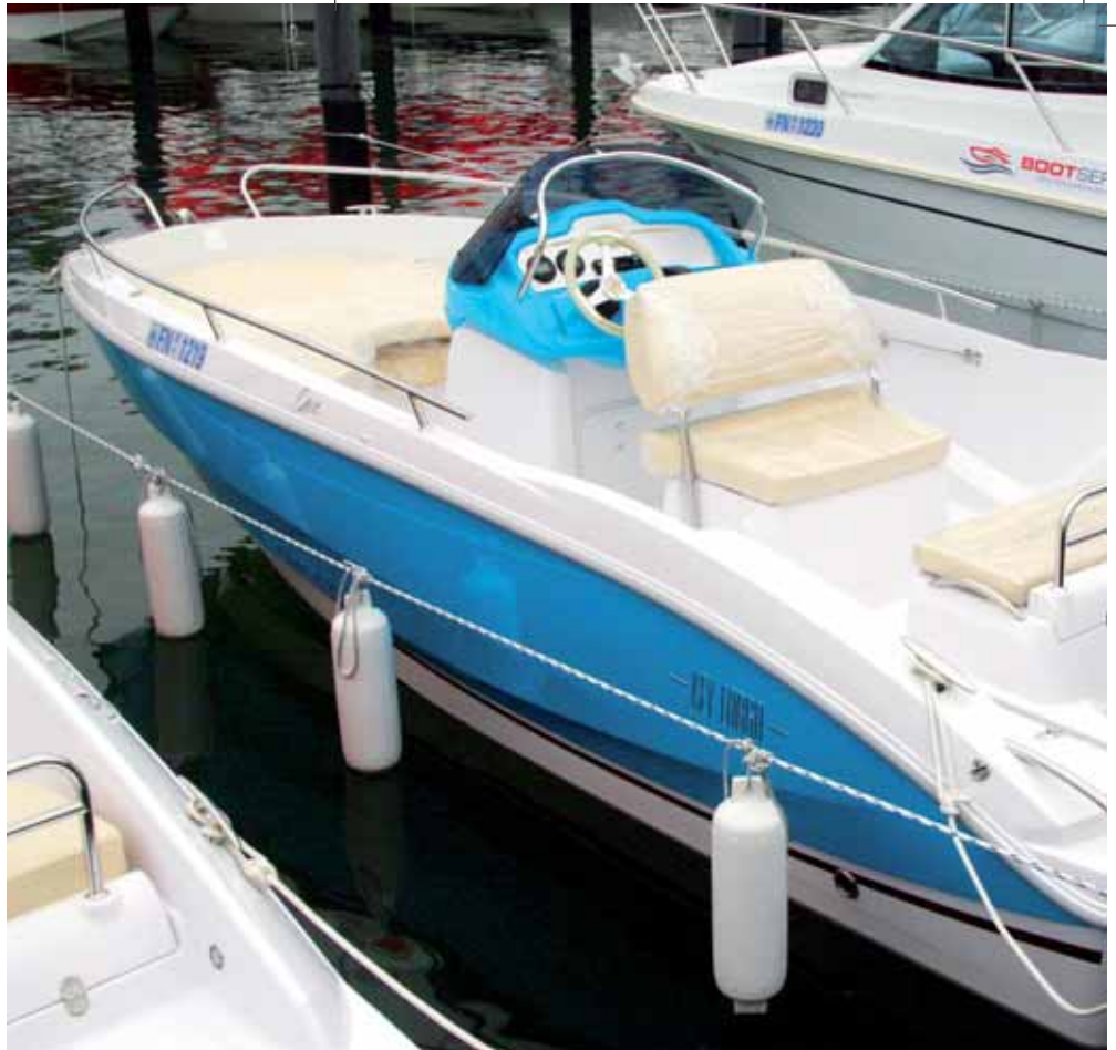
Kleines Boot mit viel Platz: Die Liegefläche im Vorschiff kann bis zur Steuerkonsole verlängert werden. Alternativ kann die Polsterauflage montiert werden. Auf dem Bild gut zu sehen ist die seitlich weit über die Wasserlinie hinausgeführte Decks-kante, was ein ge
