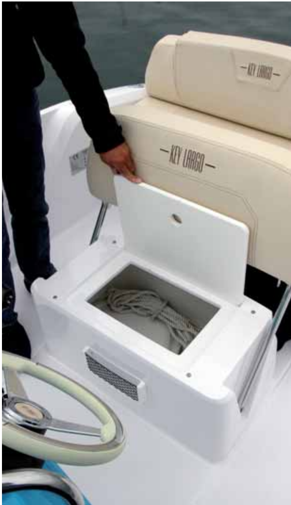
Unter dem Fahrersitz ist Stauraum. Davor ist ein kleines Gepäcknetz montiert. Gut zu sehen ist die Befestigung der umklappbaren Lehne.
