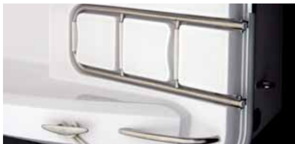
Die Badeleiter ist in den Durchstieg zur Plicht versenkt montiert.
