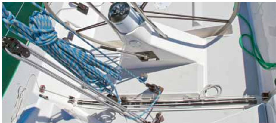
Die Steuerzentrale. Traveller, Großschot und Pumpe sowie Ventil für das Achterstag sind vor dem Ruder.
