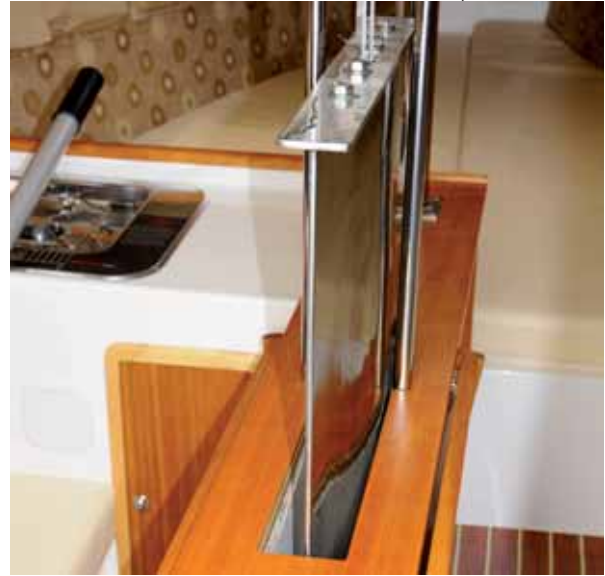
Saubere Arbeit: Die Kieflosse ist aufwändig aus Edelstahl geschweißt und mit einem hinterschnittenen Profil versehen.
