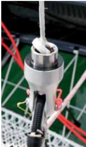
Gennaker und Code Zero werden mit einem Fallschloss befestigt, um keine Stauchkräfte durch das Fall im Mast zu erzeugen.
