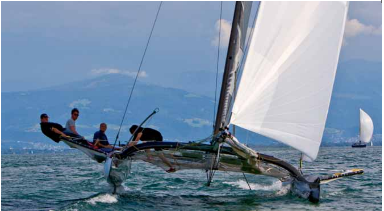
Durch die beiden klappbaren Ausleger ist effektiver Gewichtstrimm möglich. Der Ausleger in Lee hebt sich übrigens automatisch etwas an, wenn der Luvausleger belastet wird.
