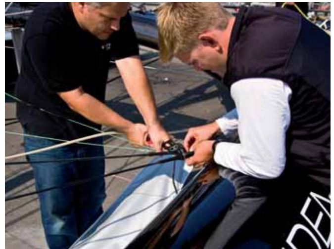
Spannen eines Lascings: Die Spannung kommt von der Winsch. Andreas Labek klemmt mit der Zange die Leine ab, während ein Mitsiegler diese von der Winsch löst und einen Knoten um alle Parten legt.
