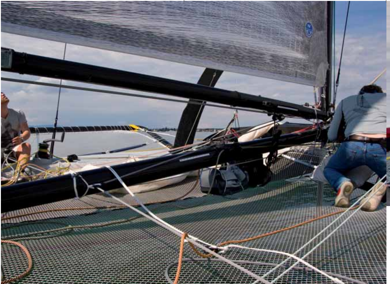
Hürdenlauf auf weichem Boden: Flexibles Trampolin mit zahlreichen Stolperfallen einschließlich Längsträger und Großbaum.
