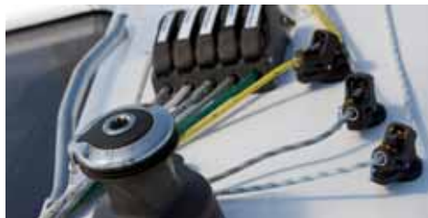
Verdeckt laufen Fallen und Strecker auf Stopper und Winsch.
