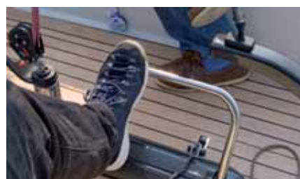
Umklappbare Fußstütze mit Travellerleinen.
