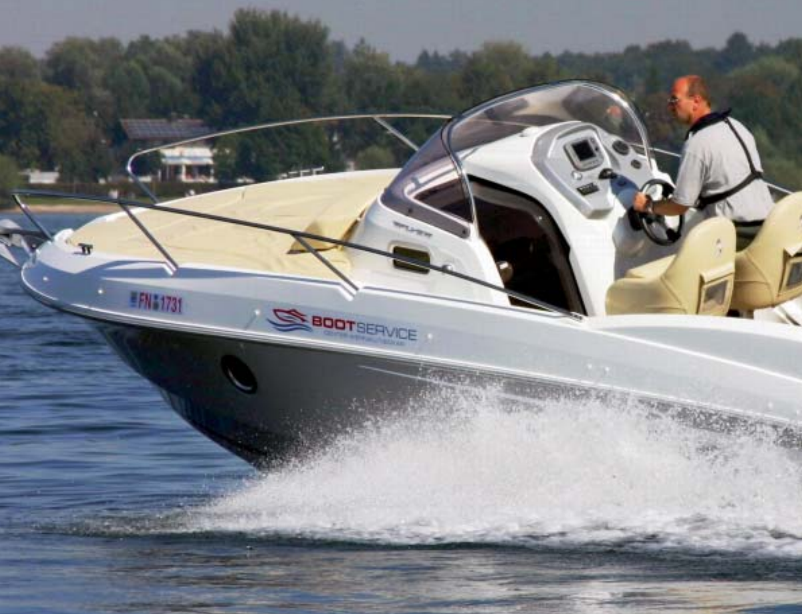
Ganz schön flott unterwegs: Mit dem 300er-Suzuki werden knapp 76 km/h (41 kn) bei einem Testgewicht von immerhin annähernd drei Tonnen erreicht.
