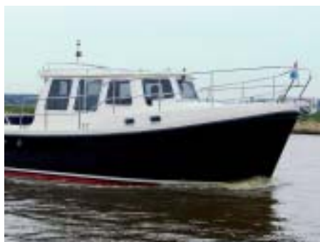
Cantia 28 Cabin Cruiser: Holländischer Verdränger aus GfK.
