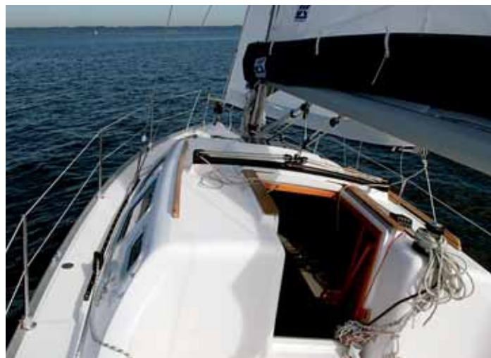
Der Traveller ist vor dem Niedergang montiert. Das spart Platz in der Plicht und erlaubt trotzdem eine halbwegs effektive Großsegelführung.
