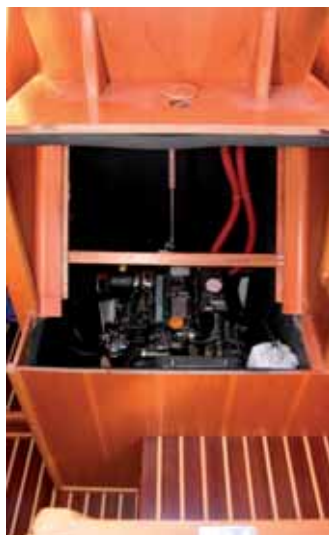
Der Motor ist unter den Niedergangsstufen eingebaut.
