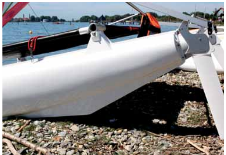
Die Ruderblätter schwenken bei Grundberührung nach oben.
