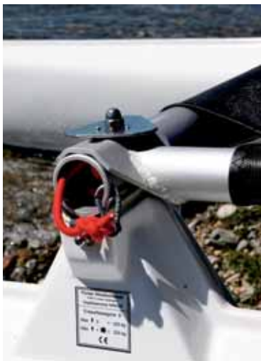
• Kenterleine ist im Beam fixiert.
