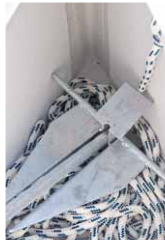
Ankerkasten mit Entwässerung an der tiefsten Stelle.
