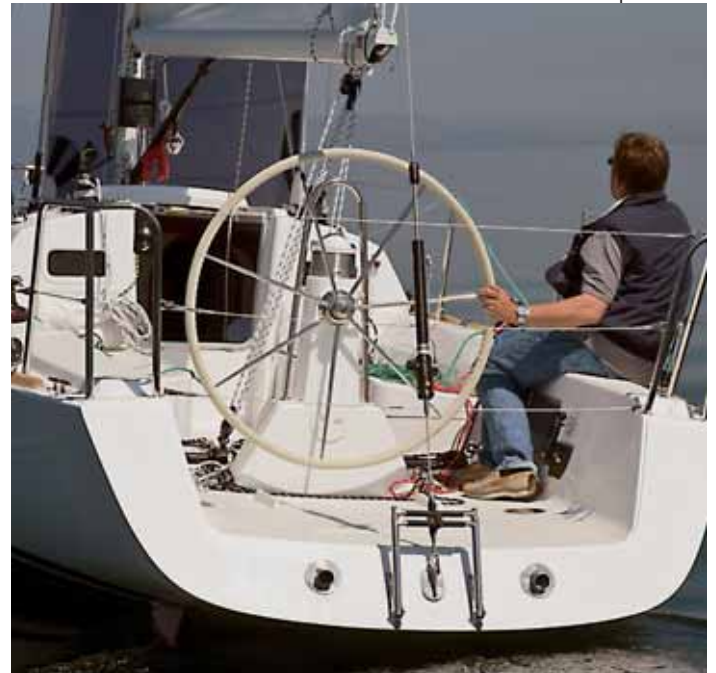
Das Cockpit der J 95 ist offen. Optional gibt es eine Backskiste, um es zu schließen. Sie ist dann Steuermannssitz.
