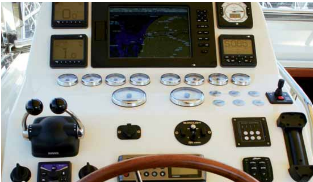
Ungewohnt ist der Gashebel links. Instrumentenposition und Plottereinbau sind vorbildlich.
