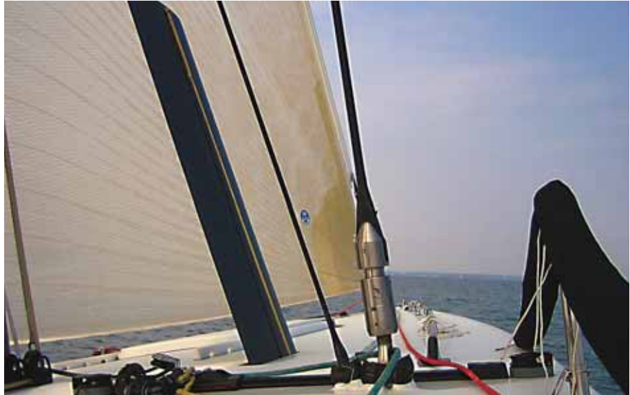
PBO-Wanten und das Luvschwert, das das Boot wegen des Cantingkiels braucht.
