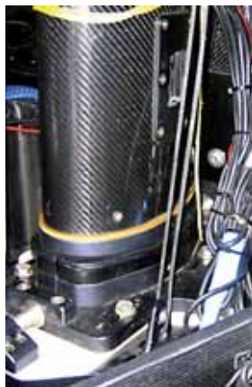
Mit Spindel und Keilen verstellbarer Mastfuß.
