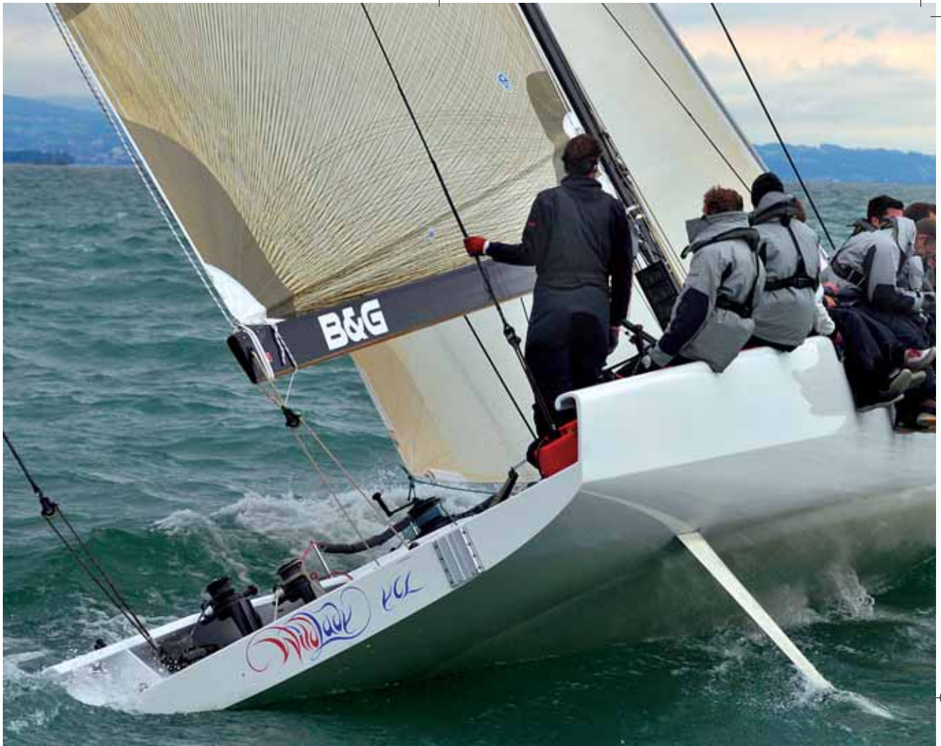
Doppelruder und Schwert, nur damit lässt sich die „Wild Lady“ auf Kurs halten.
