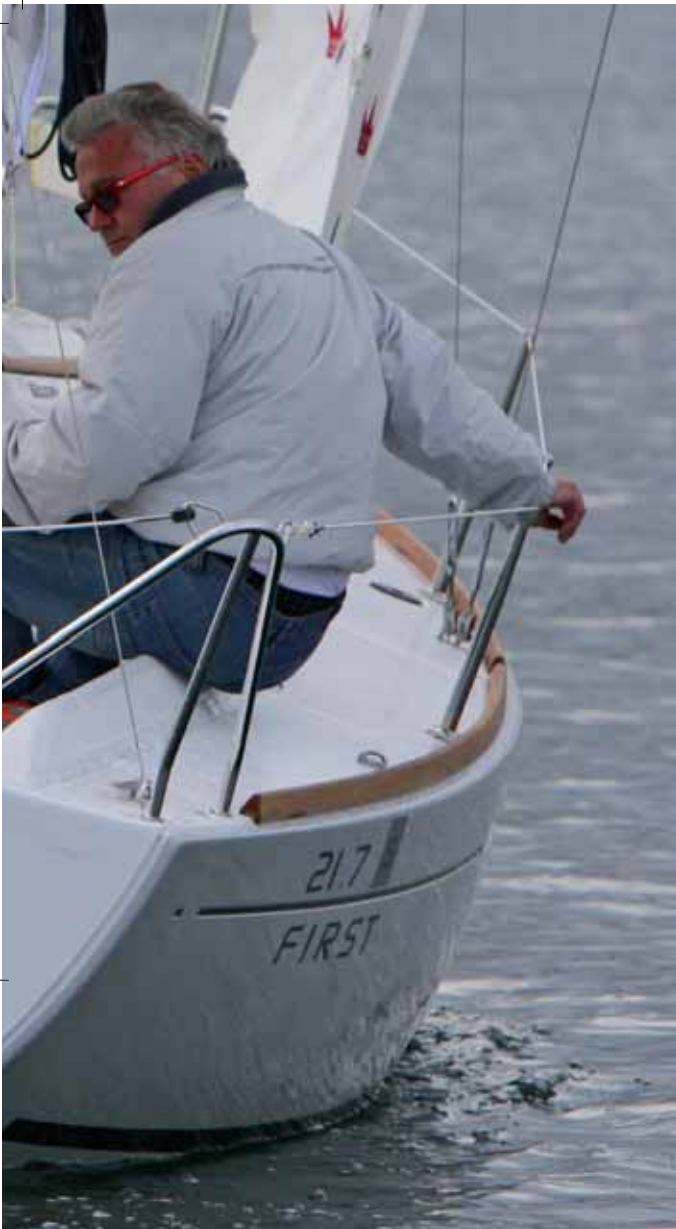
Der optionale Außenborder strömt die Ruderblätter nicht an und muss deshalb bei engen Manövern mitgedreht werden. Die Badeleiter ist bereits in der Standardausführung enthalten. Die hochklappbare Motorhalterung am Edelstahlblech ist zweckmäßig, ließe sich vielleicht aber noch etwas ästhetischer lösen.
