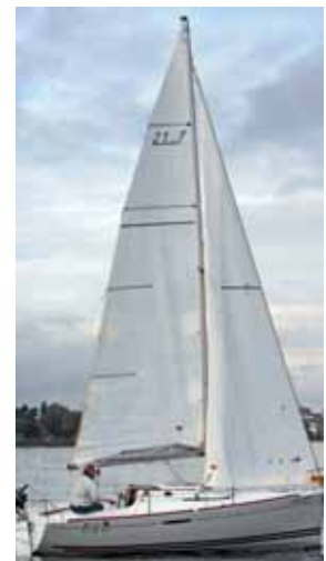
Das Vorstag setzt etwas unterhalb des Masttopps an.
