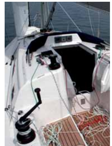
Der Niedergang ist etwas in den Aufbau hinein verschoben, was die Vorteile bei der Bedienung der Fallen un
