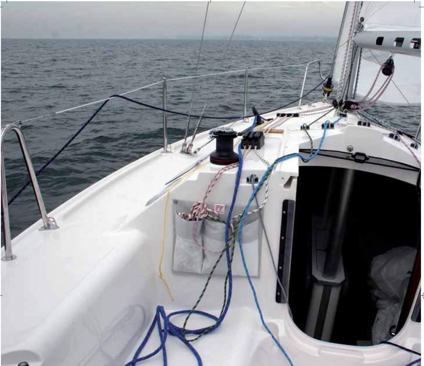
Das Decklayout ist übersichtlich und die Ausrüstung kommt vorwiegend von Ronstan und Harken. Unter Deck ist der Kielkasten zu sehen. Der Gennaker wird in de
