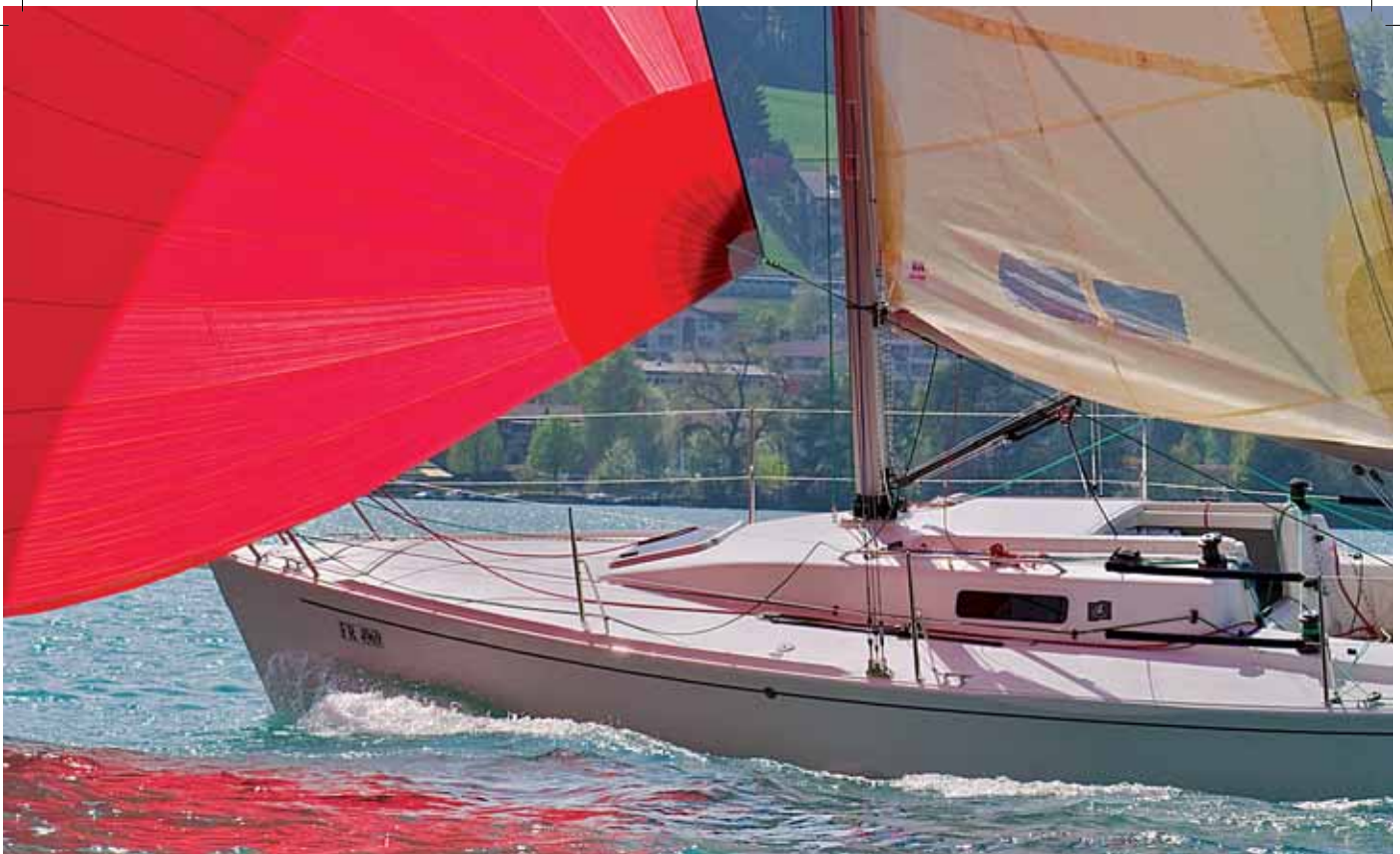
Die J 92 sl mit dem fast 100 Quadratmeter großen Gennaker, der an einem ausfahrbaren Karbonbugsprit gesetzt wird. Hier läuft das Boot seine Rumpfgeschwin
