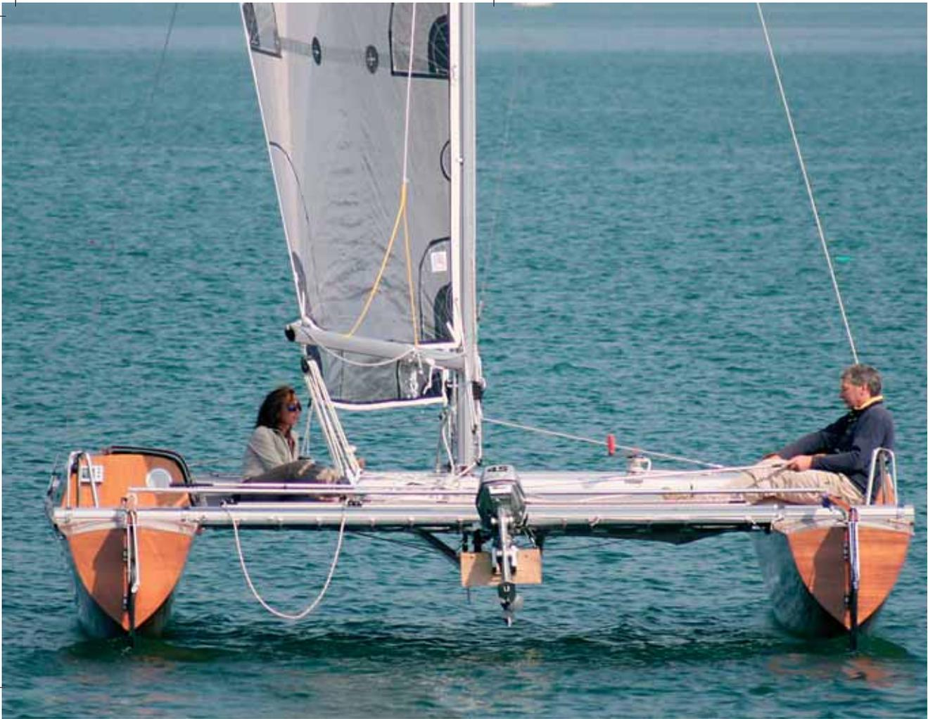
Deutlich ist hier die tiefe Spantform der Rümpfe zu erkennen, die ausreichend Lateralwiderstand bringt, sich aber mit geringstem Fahrtwiderstand durchs Wasser bewegt. Die Wellenbildung an den Rümpfen ist minimal.
