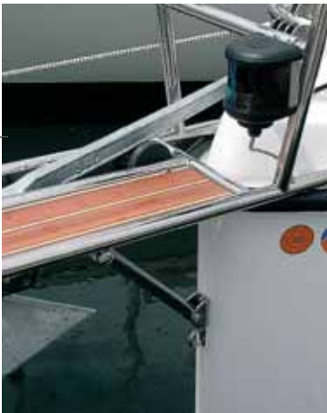
Bugsprit mit Tritt und Anker.
