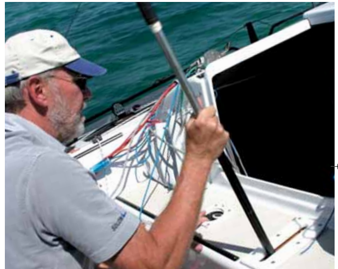
Werner Hemmeter pumpt den Kippkiel hydraulisch nach Luv.
