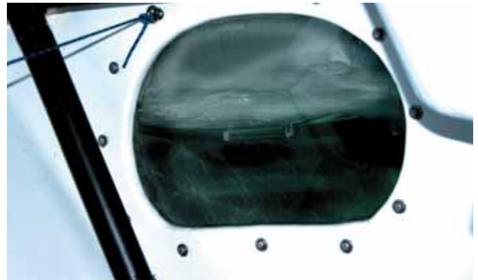
Der Luvwassertank ist gefüllt. Das Wasser wird in den Tank gepumpt, wenn man den zusätzlichen Ballast braucht.
