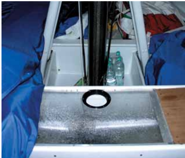
Sichtfenster für den Kippkiel. Durch die Luke kann man einen Stab mit Messer greifen, um Kraut an der Kielvorderkante abzuschneiden.
