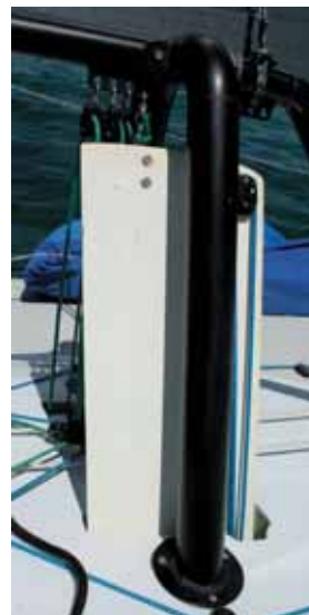
Ist der Kiel gekippt, wird das Lee-foil abgesenkt. Es erzeugt Lift.
