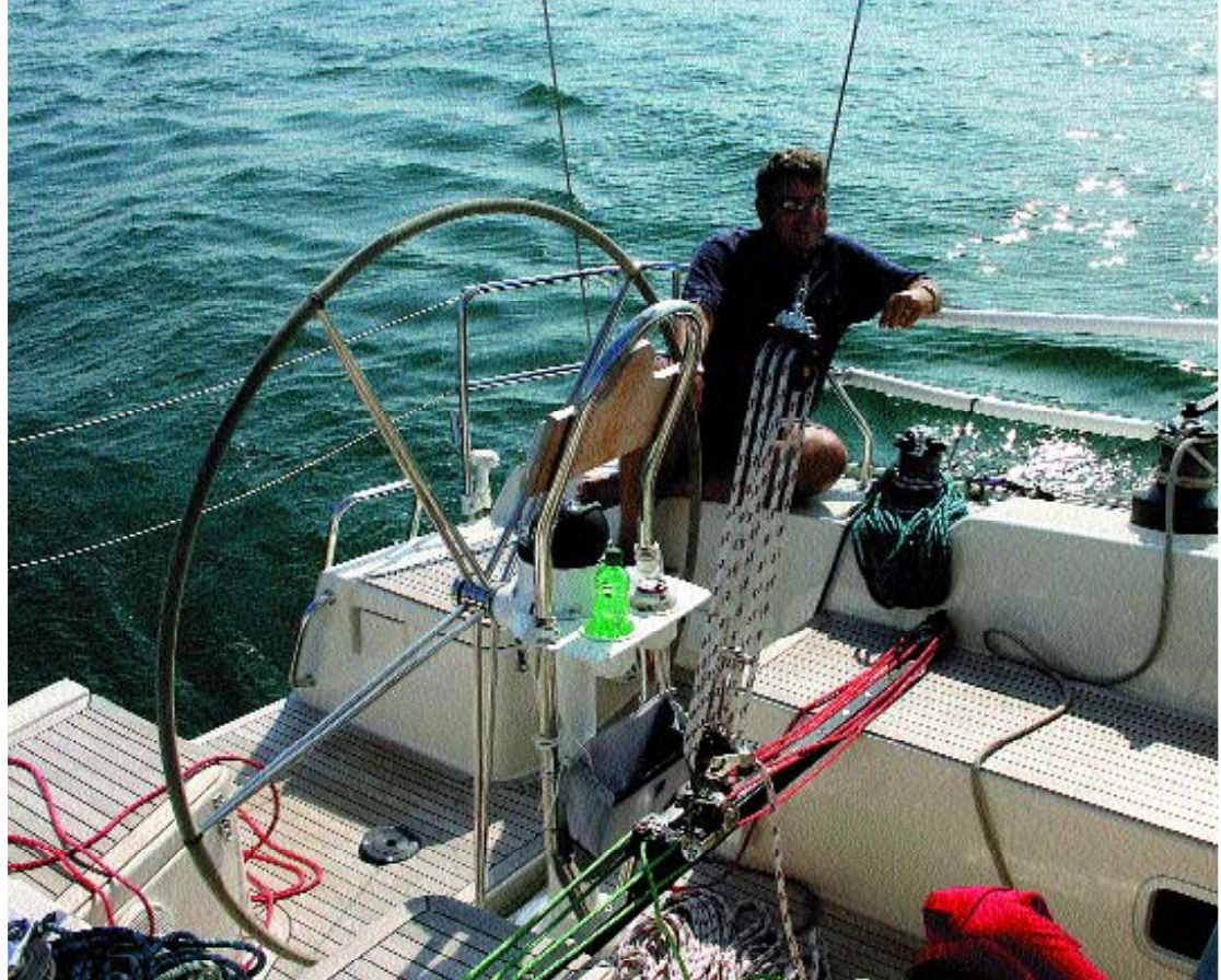
Oben links: Das geräumige Cockpit ist ergonomisch sinnvoll gestaltet und bietet eine gute Sitzposition für den Steuermann. Der Traveller ist bei der Standardausstattung auf dem Aufbau.
