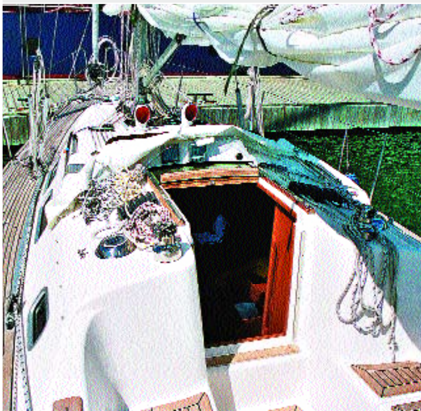
Unten links: Die Sprayhood ist optional und wird nur bei Bedarf hoch geklappt. So gelangt man beim Segeln an alle Strecker und Falen. Vorbildlich ist die große Anzahl der Lüfter.
