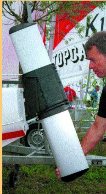
Das patentierte Surfruder kann entweder mit der Reißleine von der tiefen Speedeinstellung in die, durch die Kielabdeckung geschützte, Surfstellung gebracht werden oder bei Grundberührung kippt das Ruderblatt nach hinten und dadurch automatisch in die Surfstellung. Fotos: Isabell Munck
