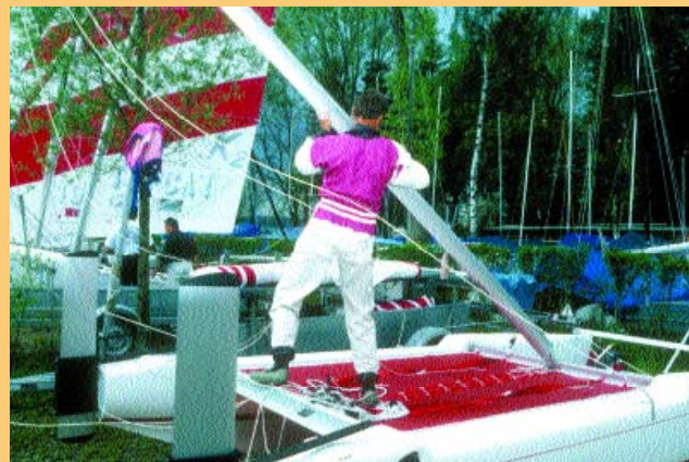
nach vorne gekippt und mit Vorstag und den Backstagen befestigt.
