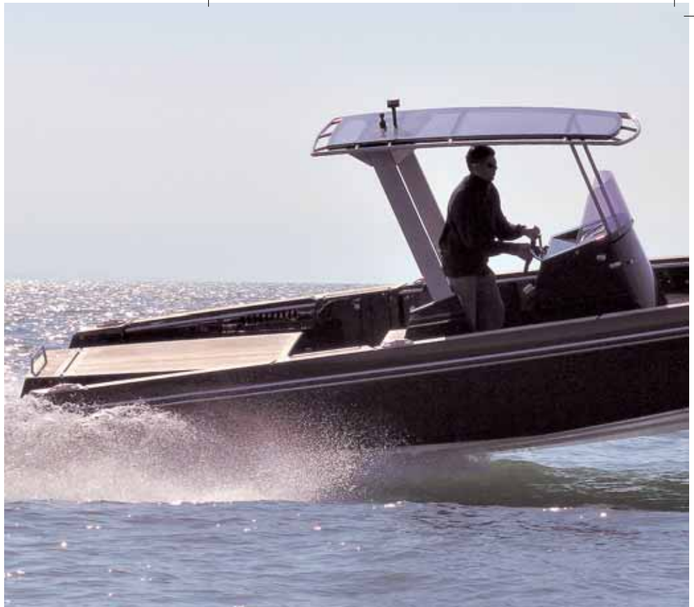
Tiefes V vorne, flaches V hinten, dazu wenig Gewicht, das sind beste Voraussetzungen für schnelles Gleiten. Gewöhnungs be
