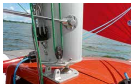
Drehbar gelagerter Mast.
