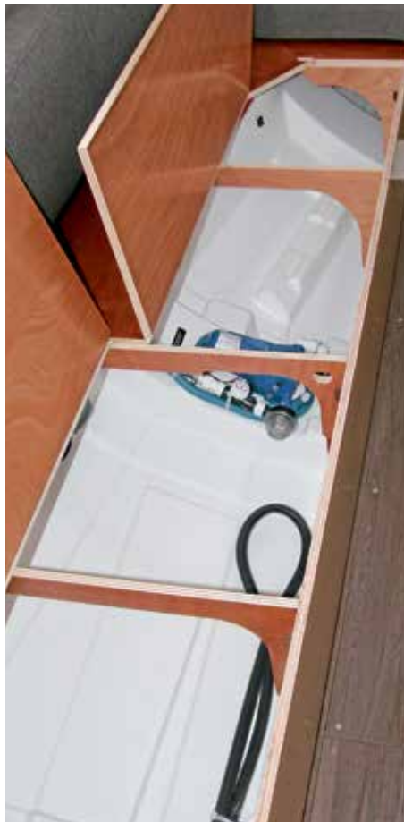
Hier wird konsequente Rationalisierung deutlich: Das Fundament für den Wasserboiler ist, für minimale Montagezeiten, gleich in die Form integriert.
