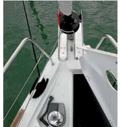
Ankerkasten mit vertikaler elektrischer Winsch und zwei Bugrollen.
