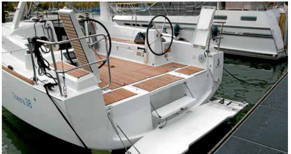
Imposantes Heck: Die klappbare Plattform ist optional, der Tritt am Rettungsinselfach ist auch in der Standard-Variante enthalten. Gasdruckfedern erleichtern den Umgang mit der Plattform.
