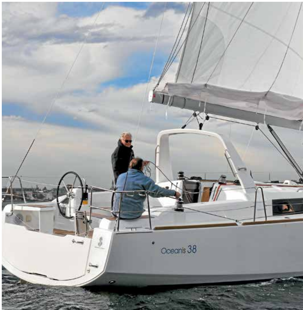
Die Fockwisch liegt im Griffbereich des Rudergängers. Die Großschot endet auf dem Kajütdach. Zwei Personen kommen gut mit gönnen.
