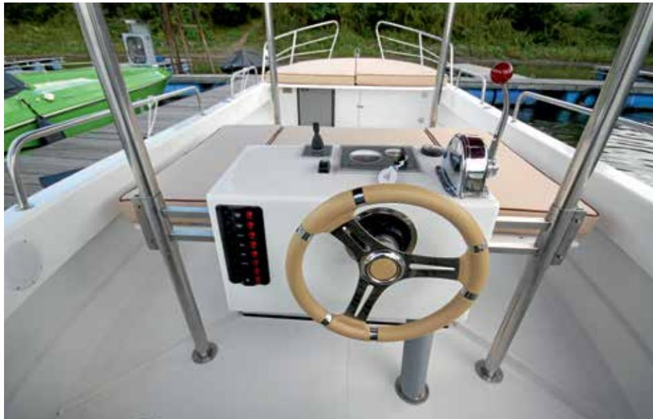
Übersichtlicher, ergonomischer Steuerstand.
