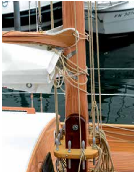
Die Fallen werden auf Belegnägeln belegt.
