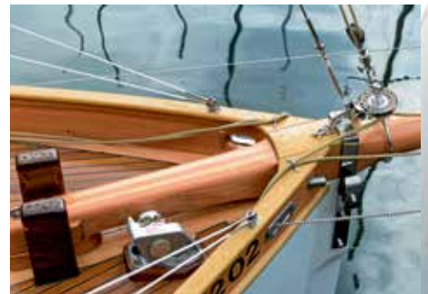
Multifunktionsbeslag hält Vorstag und Klüverbaum, der Klüverroller sitzt auf einem Ausholring.
