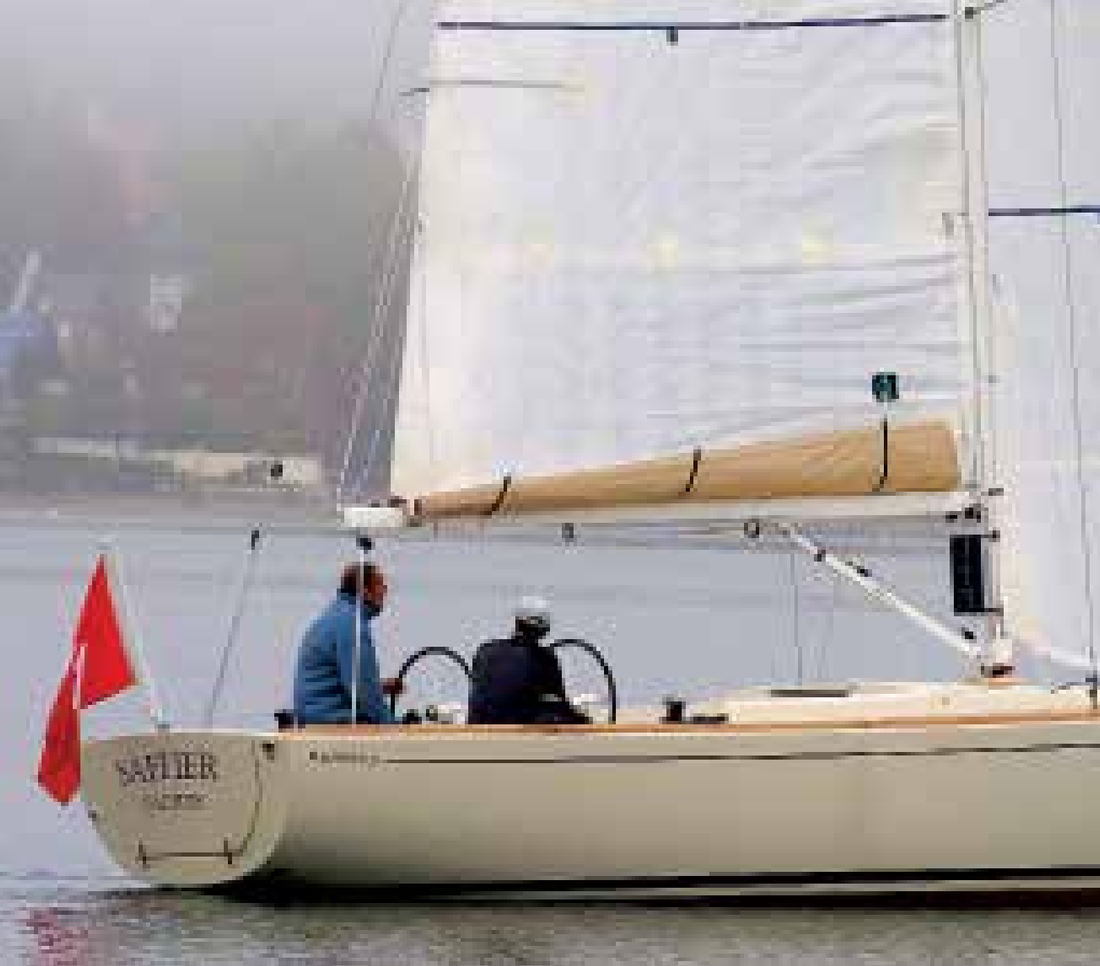
Die Linien der Saffier 33 muten oberhalb der Wasserlinie klassisch an. Gerader Steven, negativer Spiegel, deutlicher Deckssprung und flacher Aufbau. Unter Wasser
