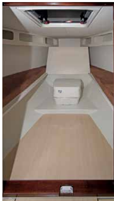
Im Vorschiff befindet sich die Toilette, die wahlweise als Trockentoilette oder mit Fäkalientank ausgeführt sein kann.
